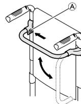
1. Pressione o pino de mola (A) na fixação do lado esquerdo e rebata a barra estabilizadora para baixo com um movimento oscilante.
