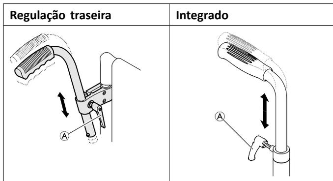
1. Para regular a altura dos punhos, desaperte o parafuso (A), empurre o manípulo até a posição pretendida e aperte novamente o parafuso.
