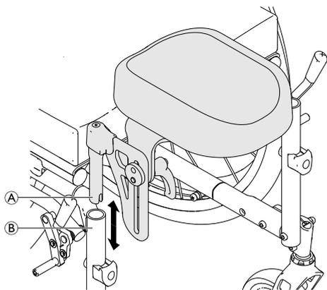
1. Retire o apoio para amputados **A** simplesmente puxando-o para fora do tubo do chassi **B**.
