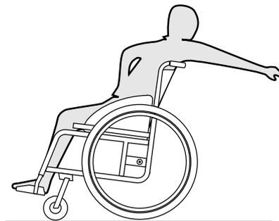
1. Posicione as rodas dianteiras para a frente. (Para tal, ande um pouco com a cadeira de rodas para a frente e depois para trás.)
