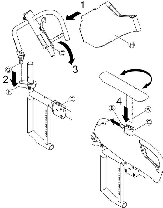
1. Instale a cobertura do apoio de braço **H** na unidade de apoio de braço, se ainda não a tiver colocado.
