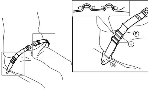
1. Passe a alça ⑥ através da fixação na cadeira ③ e, em seguida, por AMBAS as fivelas de plástico ④.
