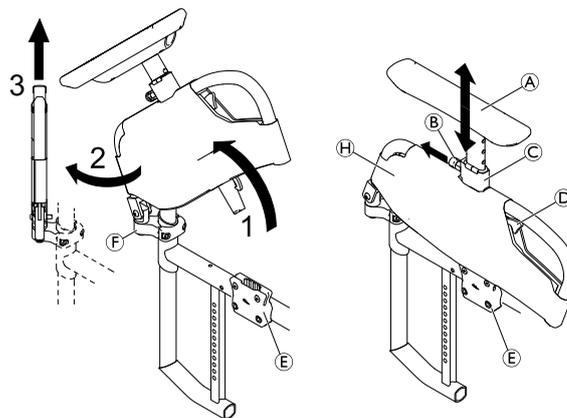
1. Empurre a alavanca de desengate ④ e rebata a unidade de apoio de braço para cima, para fora do suporte do apoio de braço ⑤.
